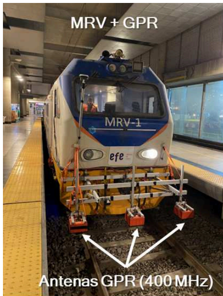
Figura 1. Instalación de antenas GPR en máquina registradora MRV.
