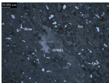
Figura 25: Aspecto dos óxidos/hidróxidos de ferro que percolam tardiamente pela rocha. Imagem em luz refletida polarizada com a objetiva de 20x.
