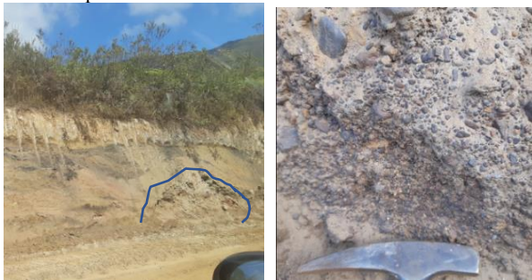
Figura 5: Fotos do mapeamento de 2020, onde se vê um aluvião (por definição) em meio a saprolite de rocha foliada.
