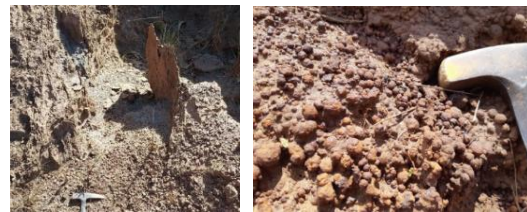
Figura 32: Veios E-W de maior resistência a erosão; e nódulos de manganês próximos ao local da L9 indicam uma laterita diferenciada com maior permeabilidade.
