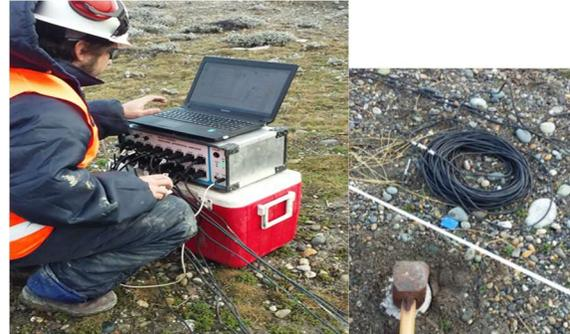
Figura 6. Equipamiento: i) hard-soft de adquisición, ii) cables, iii) geófonos de baja frecuencia, v) masa boleó, vi) disco de impacto.
