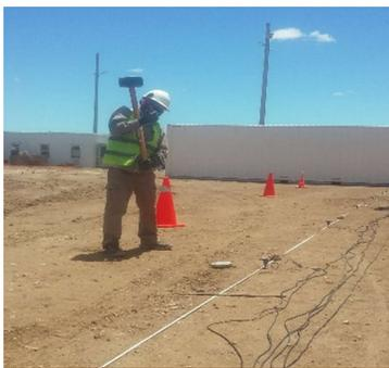
Figura 5. Lay-out básico de adquisición de datos de línea sísmica.
