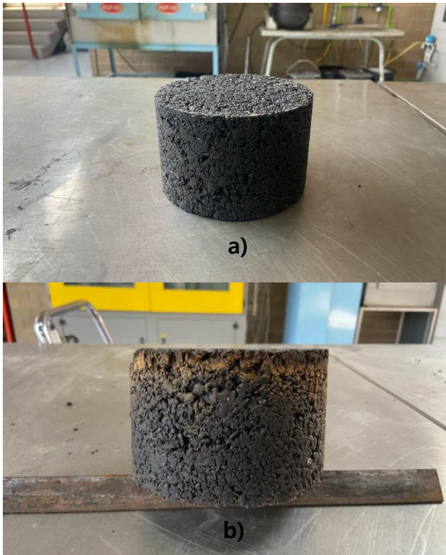
Figura 3. Efecto de un año de intemperismo en una probeta cilíndrica de concreto asfáltico. a) Probeta antes del ser sometida a intemperismo, imagen superior. b) Probeta después de un año de intemperismo, imagen inferior.
