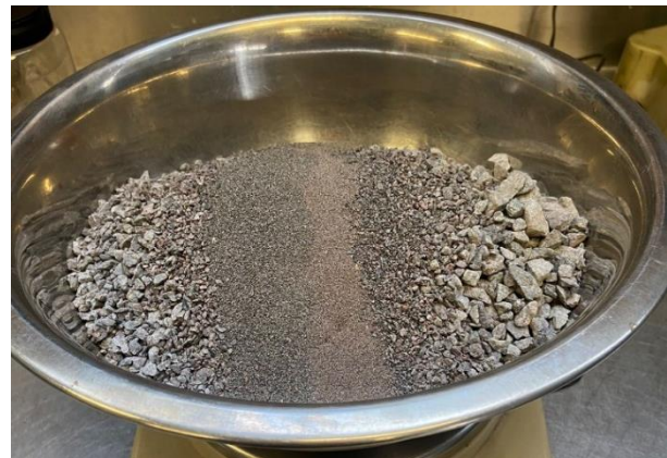
Figura 1. Agregado pétreo empleado, basalto.
