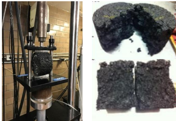
Figura 5. Ejecución del ensayo IDEAL-CT, concreto asfáltico en condición original.
