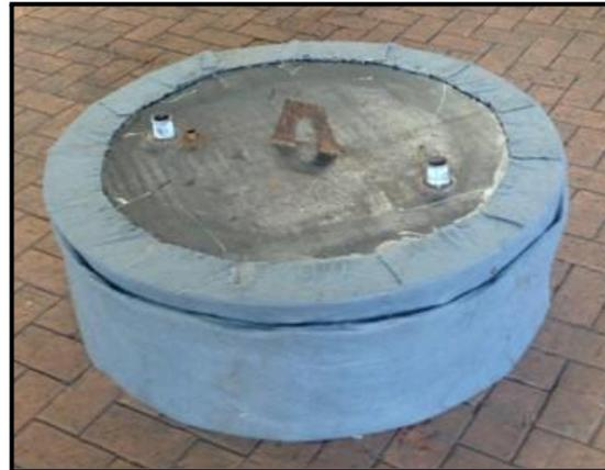
Figura 11 (a).- Celda para diámetro mayor a 600 mm (Murillo et al.)
