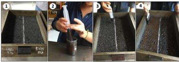
Figura 3. Aplicación de emulsión asfáltica
