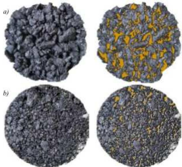
Figura 13. Áreas de no contacto en la interfaz. a) OGFC b) Densa.
