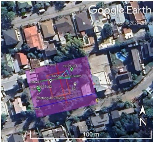
Figura 5. Ubicación en planta de exploraciones geotécnicas del sitio de estudio.
