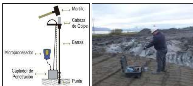
Figura 4. Ejecución ensayos PANDA® en canchas de prueba.
