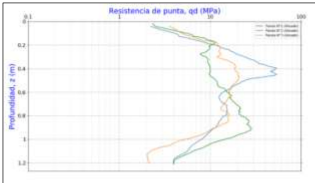
Figura 11. Penetrogramas de resistencia ensayos Panda®. Relleno solo con material arenoso disponible.
