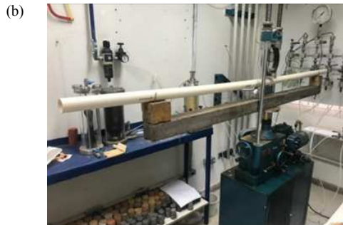
Figura 2: (a) cano do inclinômetro convencional em alumínio; (b) medição da deformação do cano de 32mm.
