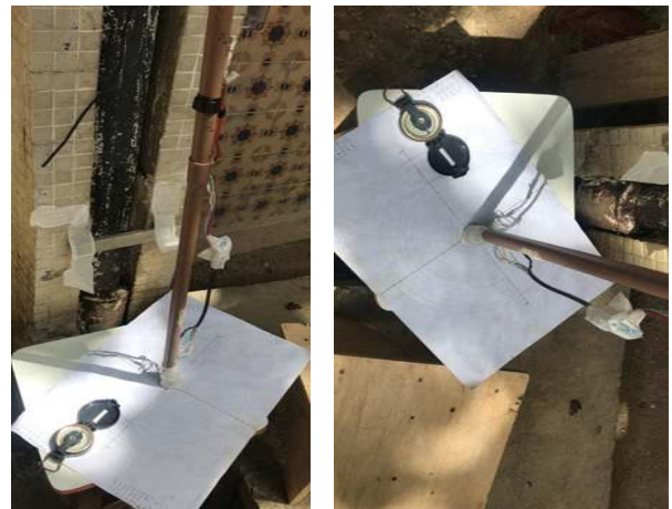
Figura 5: Demonstração do processo de aferição dos deslocamentos com uso de bússola e gráfico da rosa dos ventos.
