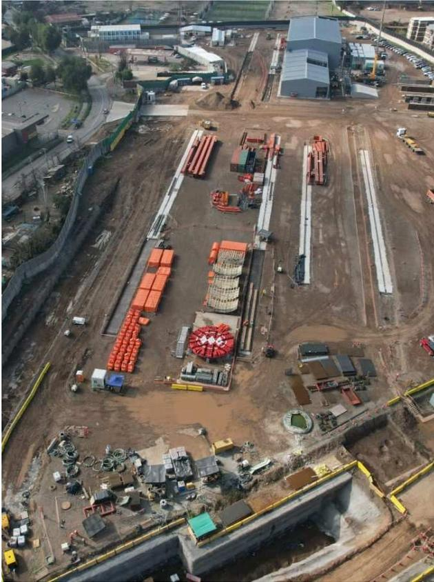
Figura 15. Planta productora de dovelas en construcción, zona de acopio de dovelas (con rueda de corte posicionada de modo temporal) y pique de acceso de la tuneladora en construcción (2023)
