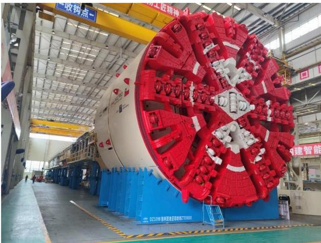
Figura 13. Tuneladora de Línea 7 montada en fábrica
