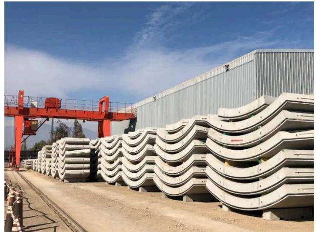
Figura 14. Dovelas para Línea 7 apiladas por anillos en zona de acopio
