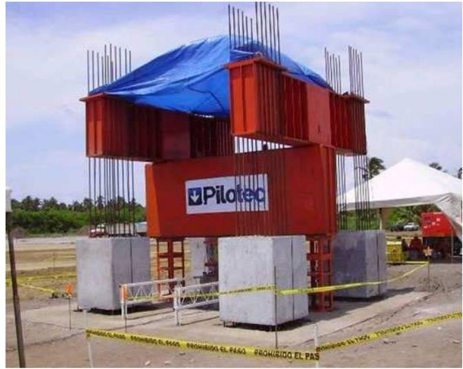
Figura 3. Arreglo en pruebas de compresión, (Paniagua 2011).
