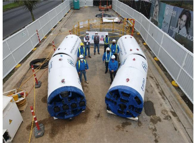
Figura 8 – MTBM AVN 1200 Marca: Herrenknecht.
