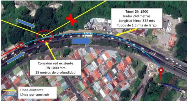
Figura 13 – Optimización de trazado, implementado curvas con radios estrechos.
