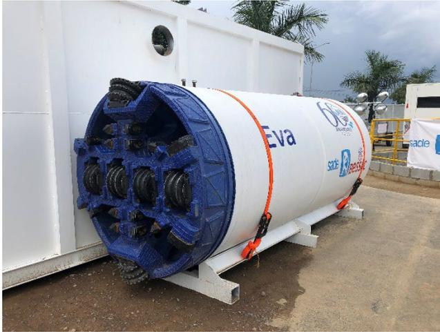
Figura 17 – Rueda de corte antes de iniciar el tramo.
