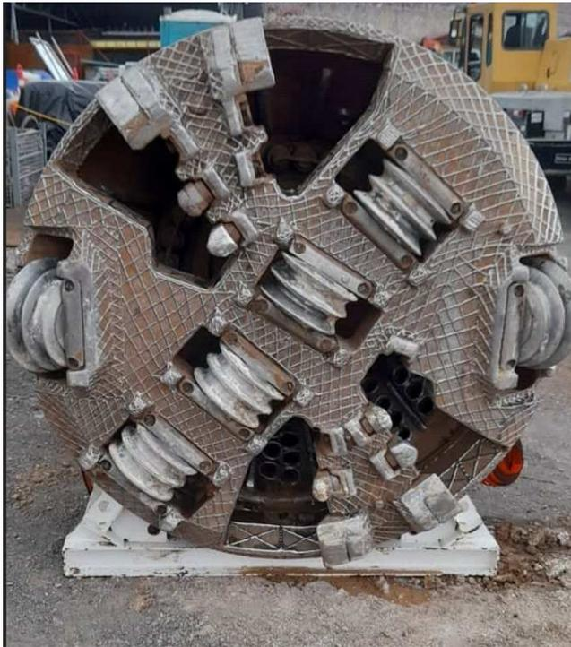
Figura 18 Rueda de corte finalizando tramo.
