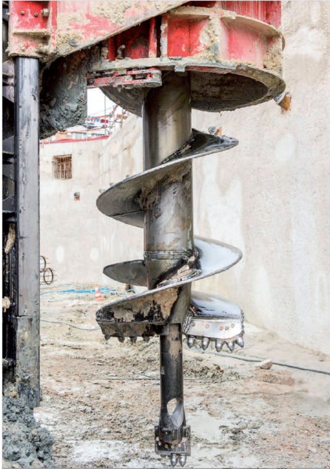
Figura 1. Tubo de inmersión telescópico en STARSOL®.
