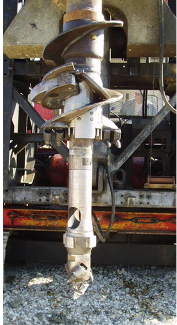
Figura 3. Tubo de inmersión telescópico y "diente" en T-PILE®.
