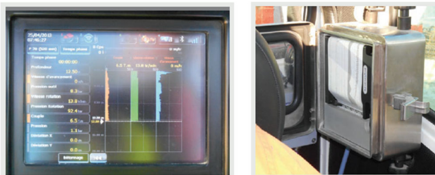
Figura 2. Sistema de registro de parámetros ENBESOL®.
