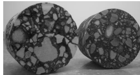
Figura 6. Núcleos de concreto asfáltico.
