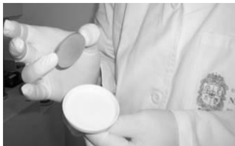
Figura 2 Muestra en pastilla para análisis de RX
