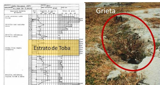
Figura 18. Sondeo geotécnico del sitio y fotografía de una grieta ocasionada por la presencia del estrato de toba
