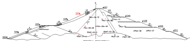
Figura 3. Localización piezómetros Presa Principal Guillermo Cano – Central Jaguas.
