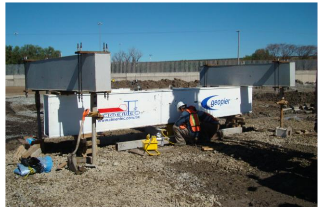
Figura 7. Ejecución de la prueba de módulo en la Pila de Agregado Compactado.
