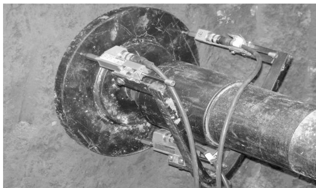
Figura 2. Ensayo PLT. Placa y sensores de desplazamiento.
