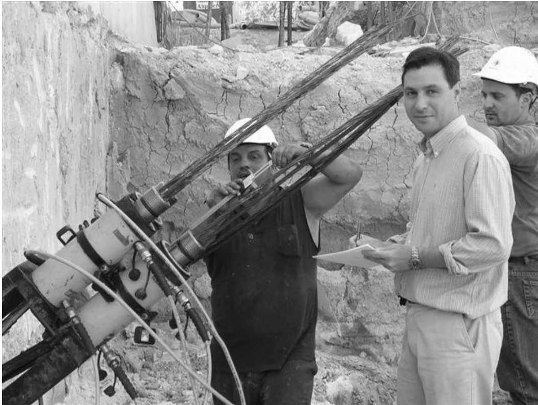
Figura 9. El ensayo de investigación con el sistema de gatos múltiple en el Parking La Vega (Murcia).
