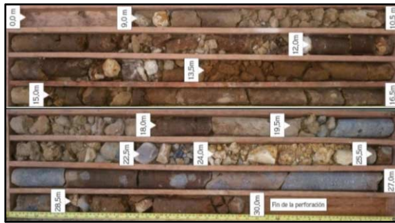
Figura 6. Recuperación de muestras típicas del lahar por medio del ensayo a rotación.
