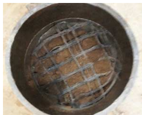
Figura 2. Posicionamento da geogrelha no cilindro.
