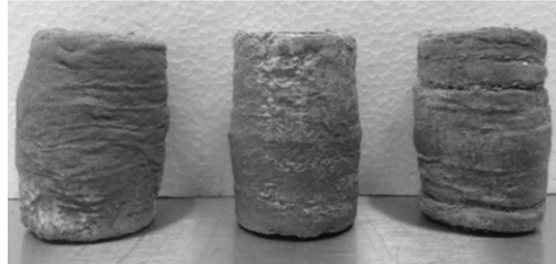
Figura 3. Probetas de suelo después de ser ensayadas (de izq. A derecha: Muestra con 0.1% de fibra, Muestra con 0.5% de fibra y Muestra con 0.7% de fibra.
